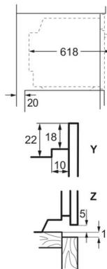
Einbaubackofen/Einbauherd + Höhenadapter
